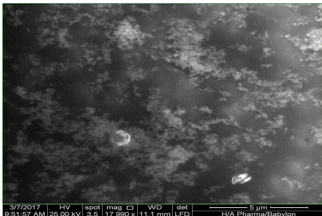
شكل (9) يوضح الصورة التكبيرية لمركب نانو الفضة الناتجة من استخدام جهاز SEM.
